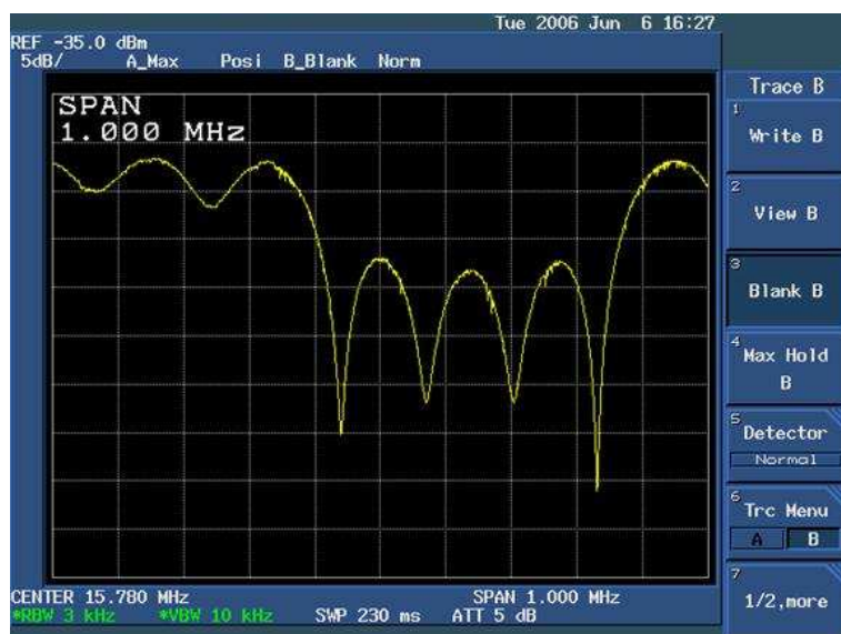
Рис. 4.24: Экспериментально полученная АЧХ при воздействии четырёх гармонических помех
