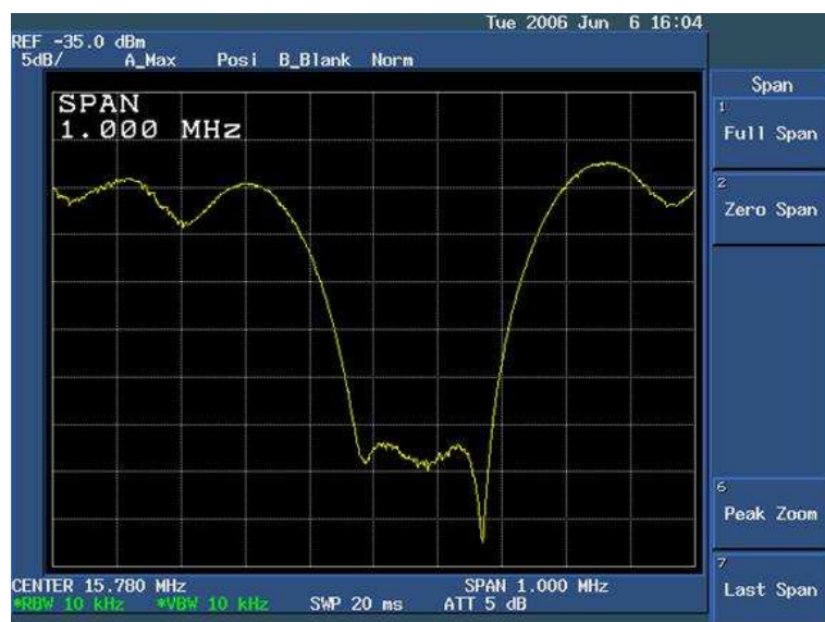
Рис. 4.26: Экспериментально полученная АЧХ при воздействии полосовой помехи
