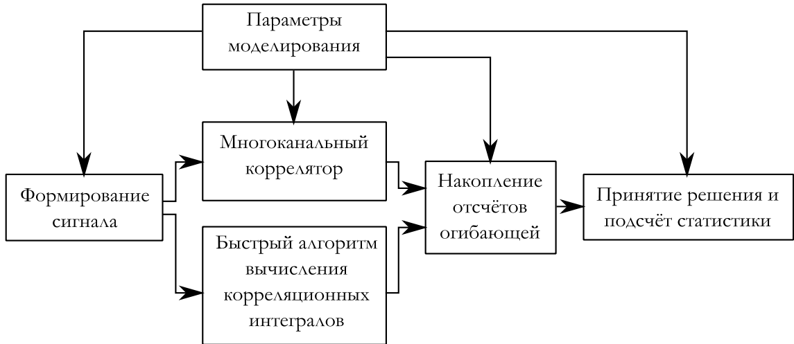
Рис. 2.8: Структура модели обнаружения сигнала
