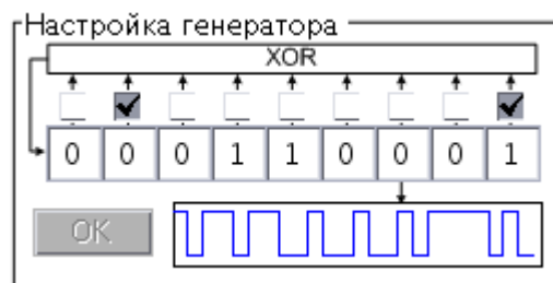
Рисунок 2 - Фрейм Настройка генератора
