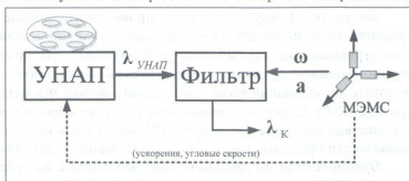
Рис. 1. Схема комплексирования на уровне первичной обработки
