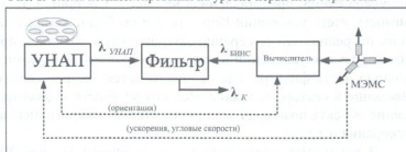
Рис. 2. Схема комплексирования на уровне вторичной обработки
